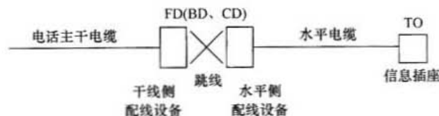
图 5.2.3-1 电话交换系统中缆线与配线设备间连接方式
