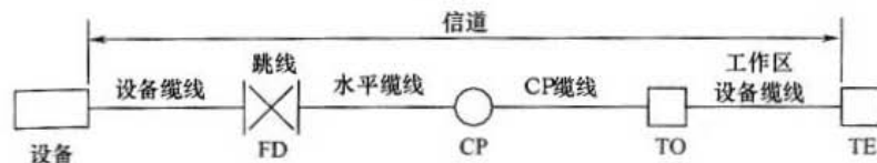
图 3.3.2 配线子系统缆线划分
